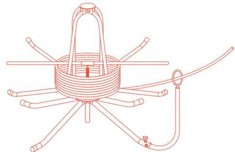
Assembler les deux poteaux dans l'embout du ressort afin d'exercer une pression sur le rouleau de PEX. Utiliser l'anneau de déroulement pour dérouler le tuyau.
