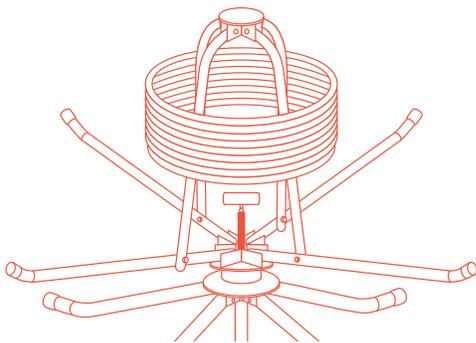
Insérer le rouleau de tuyau PEX sur le corps du dérouleur.
