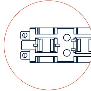
Imbriquer les bandes les unes après les autres à l'aide des attaches, en veillant à respecter un espacement minimum de 48 pouces entre elles.
