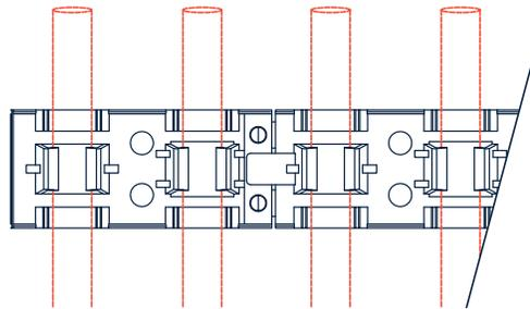
Insérer les tuyaux 1/2" ou 5/8" dans la bande de fixation en fonction de votre plan de bouclage.
